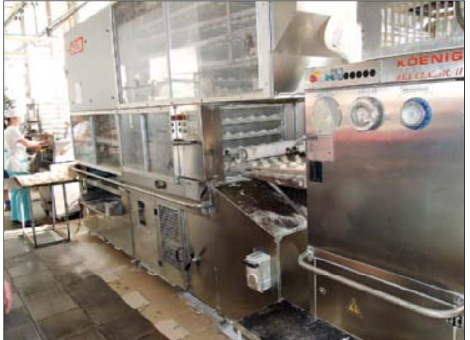
На фото сверху: импортный комплект разделки теста фирмы Kenig, им управляет преобразователь Веспер
