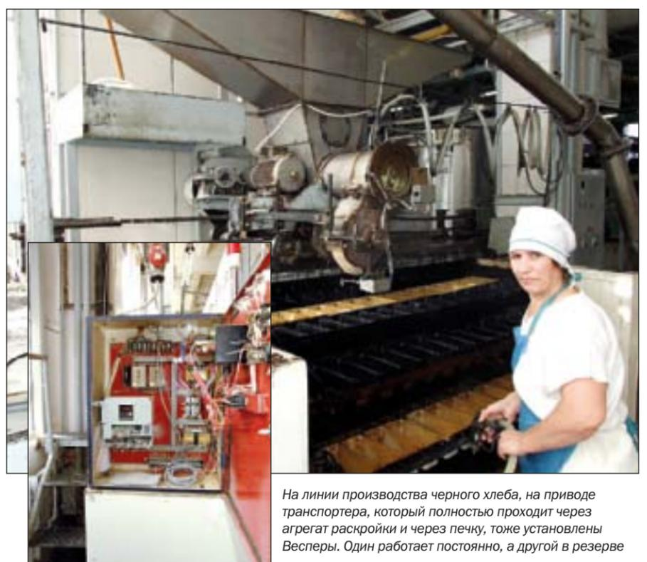
На линии производства черного хлеба, на приводе транспортера, который полностью проходит через агрегат раскройки и через печку, тоже установлены Весперы. Один работает постоянно, а другой в резерве
